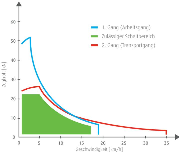
Shift in Motion ist ein Fahrtrieb mit elektrohydraulisch synchronisierten Schaltvorgängen eines Stillstands-Schaltgetriebes bei fahrender Maschine. Shift in Motion eignet sich besonders für Fahrzeuge, die häufig zwischen Transport- und Arbeitsgang wechseln, also sowohl hohe Zugkraft als auch hohe Endgeschwindigkeit von über 25 Kilometern pro Stunde benötigen.
